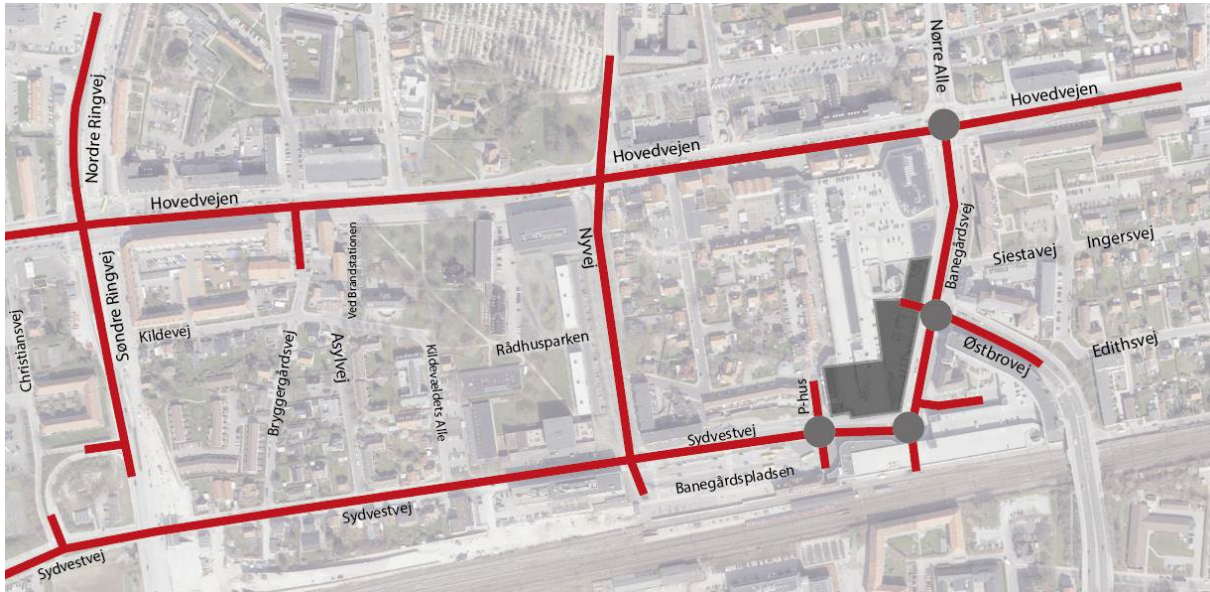
Figur 8 Modelvejnet vist med rød markering. Grå prikker viser de fire kryds der udtrækkes resultater for i analysen /38/
